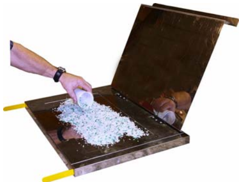
Θρυμματισμένο πλαστικό το οποίο τοποθετείται στο δίσκο της πρέσας R30
